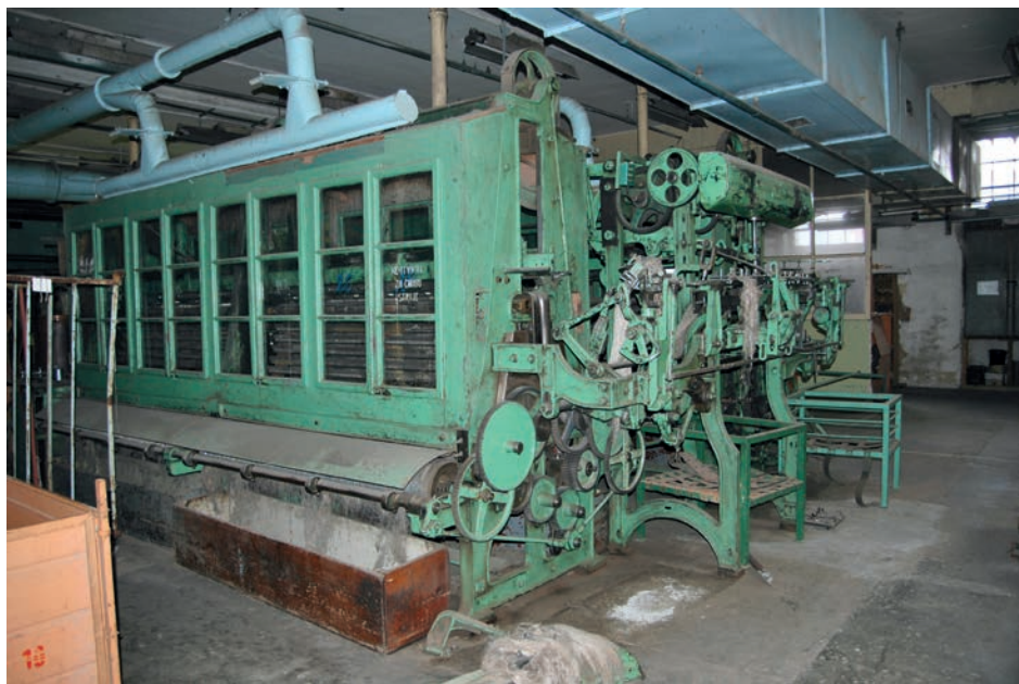
Sudkov, továrna na lněné zboží Ignaz Seidl / Moravolen, jejíž provoz byl ukončen v 90. letech 20. století. Jeden ze čtyř vohlovacích strojů od firem James Mackie & Sons (na snímku) a S. Cotton & Co. z Belfastu, pořízených zřejmě kolem roku 1910. Přestože byla kontaktována technická muzea, nepodařilo se žádný ze strojů z kapacitních důvodů zachránit. Foto Michaela Ryšková, 2006. • Sudkov, Ignaz Seidl / Moravolen linen goods factory, which was closed down in the 1990s. One of the four heckling machines made by James Mackie & Sons (shown in the photograph) and S. Cotton & Co. of Belfast, probably purchased around 1910. Although several technical museums were approached, none of them was able to accept the machines due to space limitations. Photograph by Michaela Ryšková, 2006.
